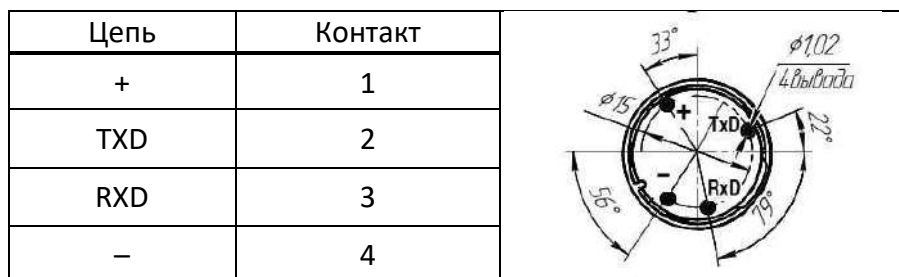
Рисунок Б.2 – Расположение выводов ДЗО
