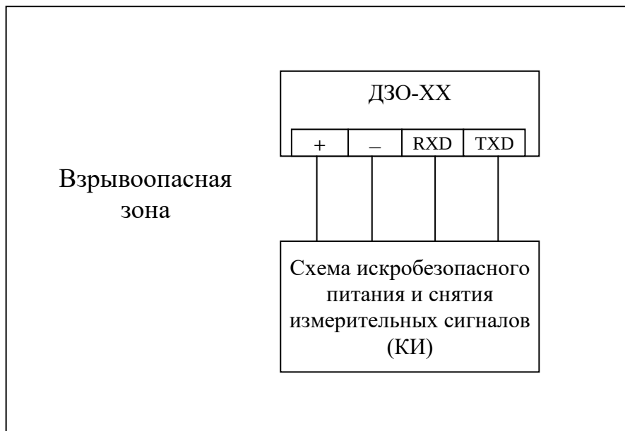
Рисунок Б.1 – Схема подключения ДЗО при эксплуатации
